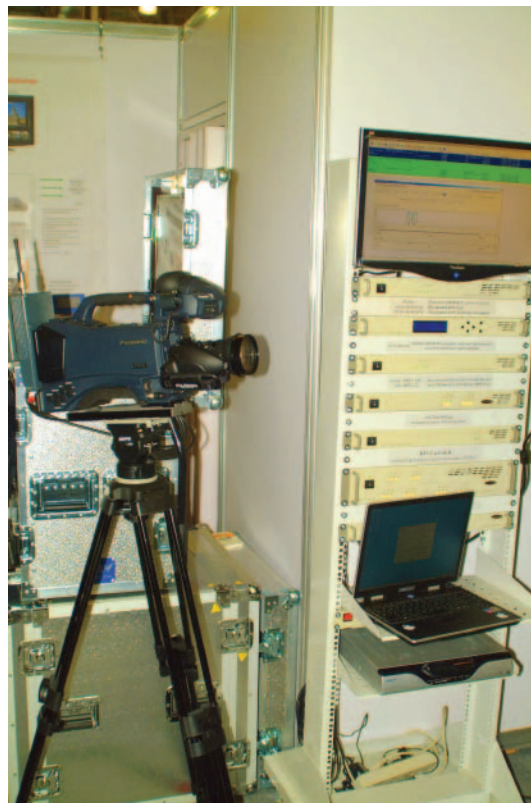
Камера с радиосистемой и стойка с оборудованием Televue для операторов кабельного ТВ
